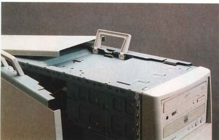
L'accesso all'interno del Naac è facilitato dalle maniglie che permettono di asportare indipendentemente le paratie laterali.
